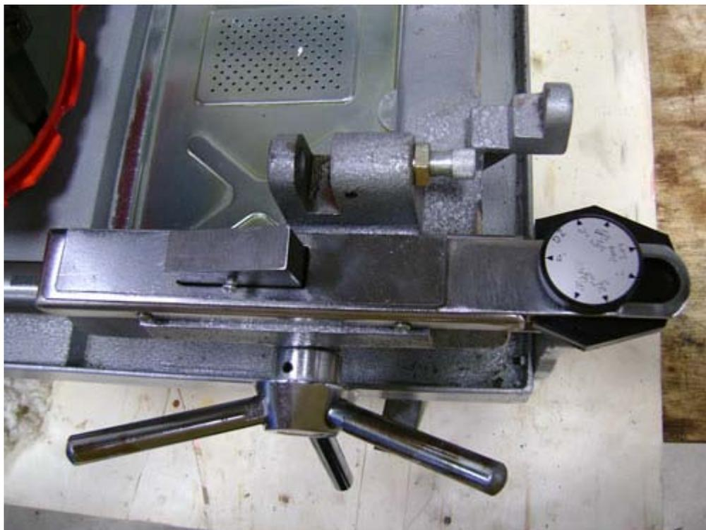
Puxe e observe que existe uma engrenagem e uma chaveta sob o carro deslizante. Retire a trava do cabeçote e o limitador de fios de rosca (botão marcador), tomando cuidado com as molas existentes. Solte a abraçadeira e retire a mangueira conectada ao espigão de entrada de óleo.
